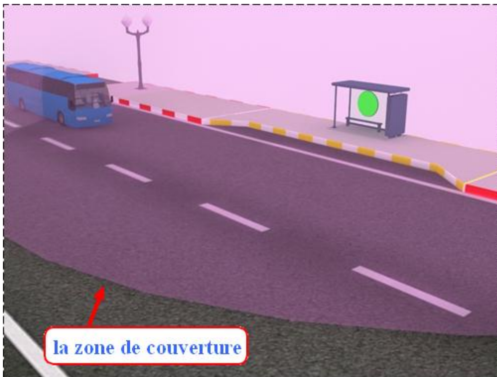
Figure II.17 bus arrive à la zone de couverture de l'arrêt de bus
