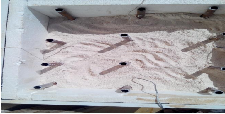
Figure III.24: illustration simplifiée de model plan de stockage thermique dans le (plâtre +sel).
