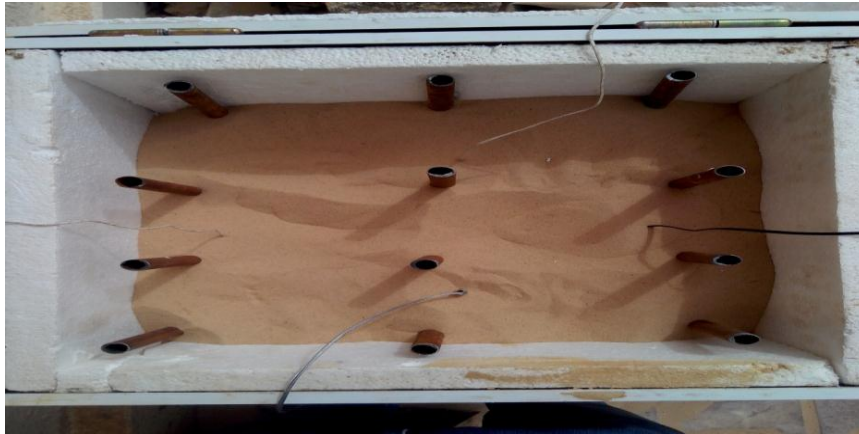
Figure III.12: illustration simplifié de model plan de stockage thermique dans sable.
