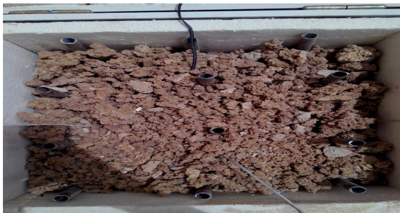
Figure III.28: illustration simplifié de model plan de stockage thermique dans le rose de sable (les roches).
