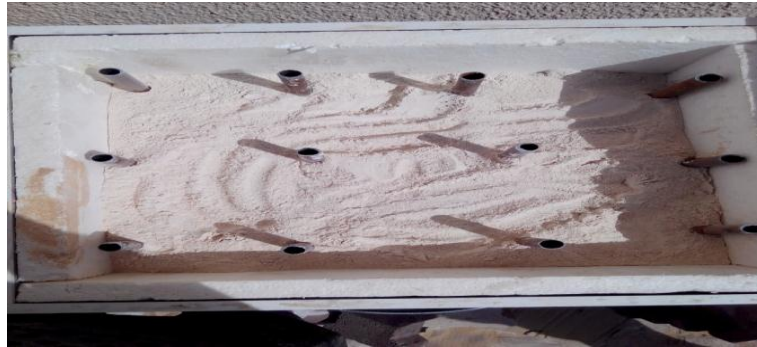
Figure III.16: illustration simplifié de model plan de stockage thermique dans le gypse.
