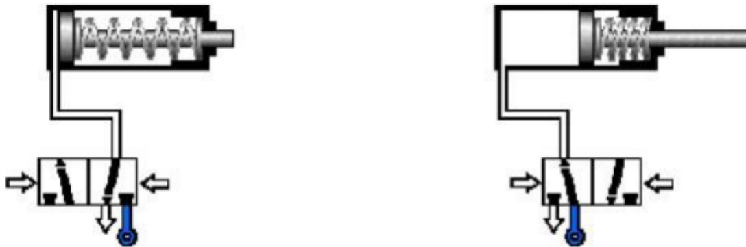
Figure 1.13 : l'alimentation d'un vérin simple effet
