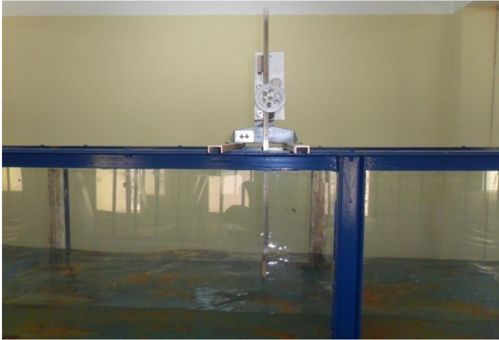
Figure 4.4 : Photographie du déversoir rectangulaire sans hauteur de pelle avec contraction latérale ayant servi à la mesure du débit
