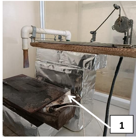
الشكل (1.III): التركيب التجريبي لجهاز الرش الكيميائي الحراري.
