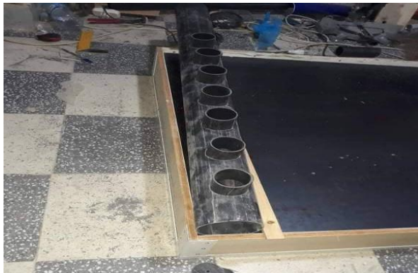
Figure III.18 : Vue de la sortie d'air du séchoir
