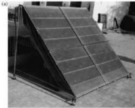
Figure 19. (a) photographie du séchoir solaire de ferme portable PAU (b) vue latérale du séchoir (c) détails du rack multi-bac, Singh et al., 2004.
