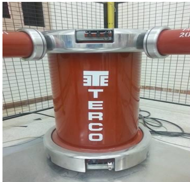
Figure II.4. Transformateur à haute tension utilisé pour l'essai de claquage de l'air.
