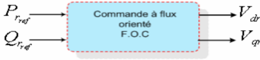
Figure IV.30 : Bloc du F.O.C (field-oriented control).
