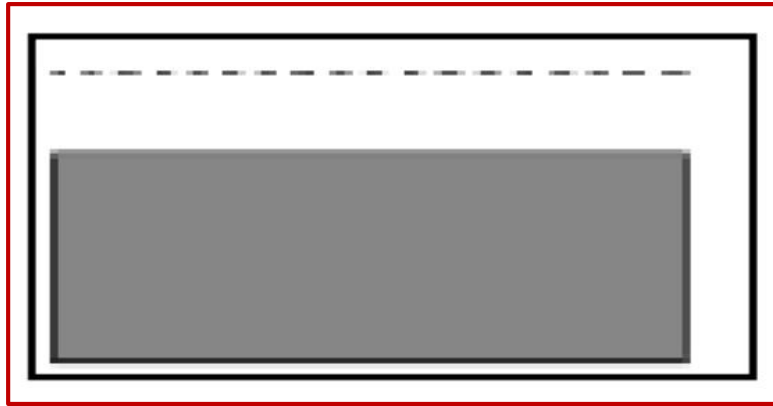
الشكل 6.I: رسم تخطيطي لتآكل المعمم [24]
