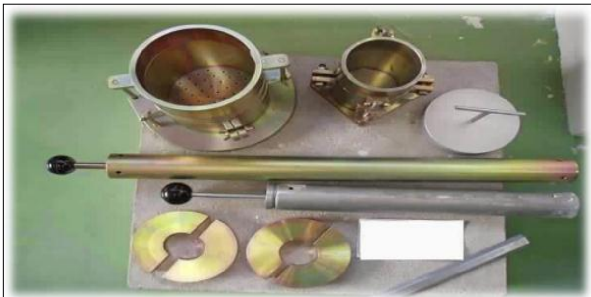
Figure 14 : Matériels pour essai Proctor (Cité par : MEBARKI ; 2008)
