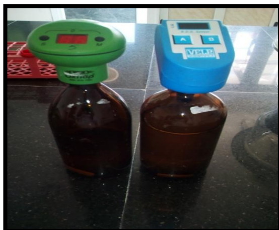
Figure 32 : Flacons de DBO 5 + Senseurs DBO 5 (OXITOP,WTW) (Photo originale, 2017).
