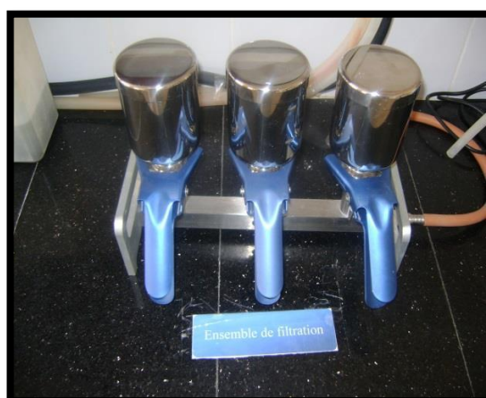
Figure 30 : Rampe de filtration (Photo originale, 2017).
