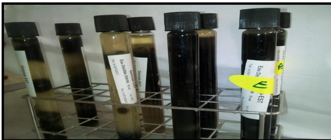
Figure 41 : Recherche des clostridium sulfito-réducteurs (Photo originale, 2017).
