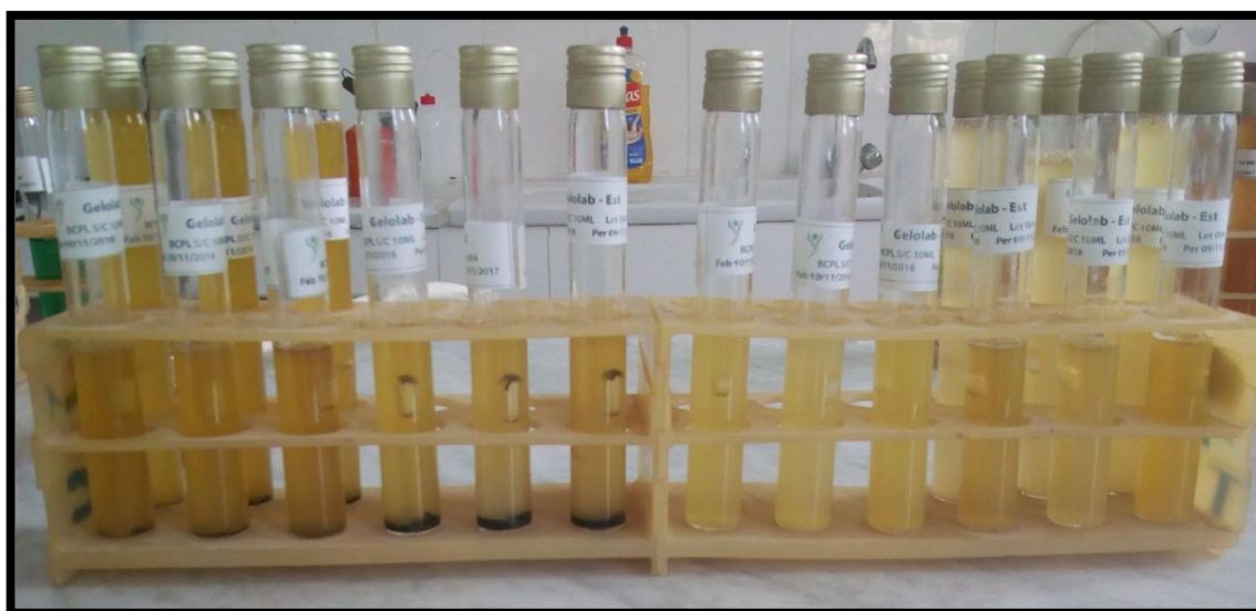
Figure 39 : Recherche des coliformes (Photo originale, 2017).
