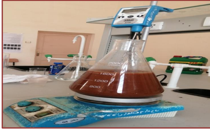
الشكل (9.III): صورة تبين معالجة العينة B1 بـ HCL
