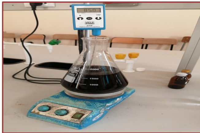
الشكل (10.III): صورة تبين معالجة العينة B2 بـ NaOH
