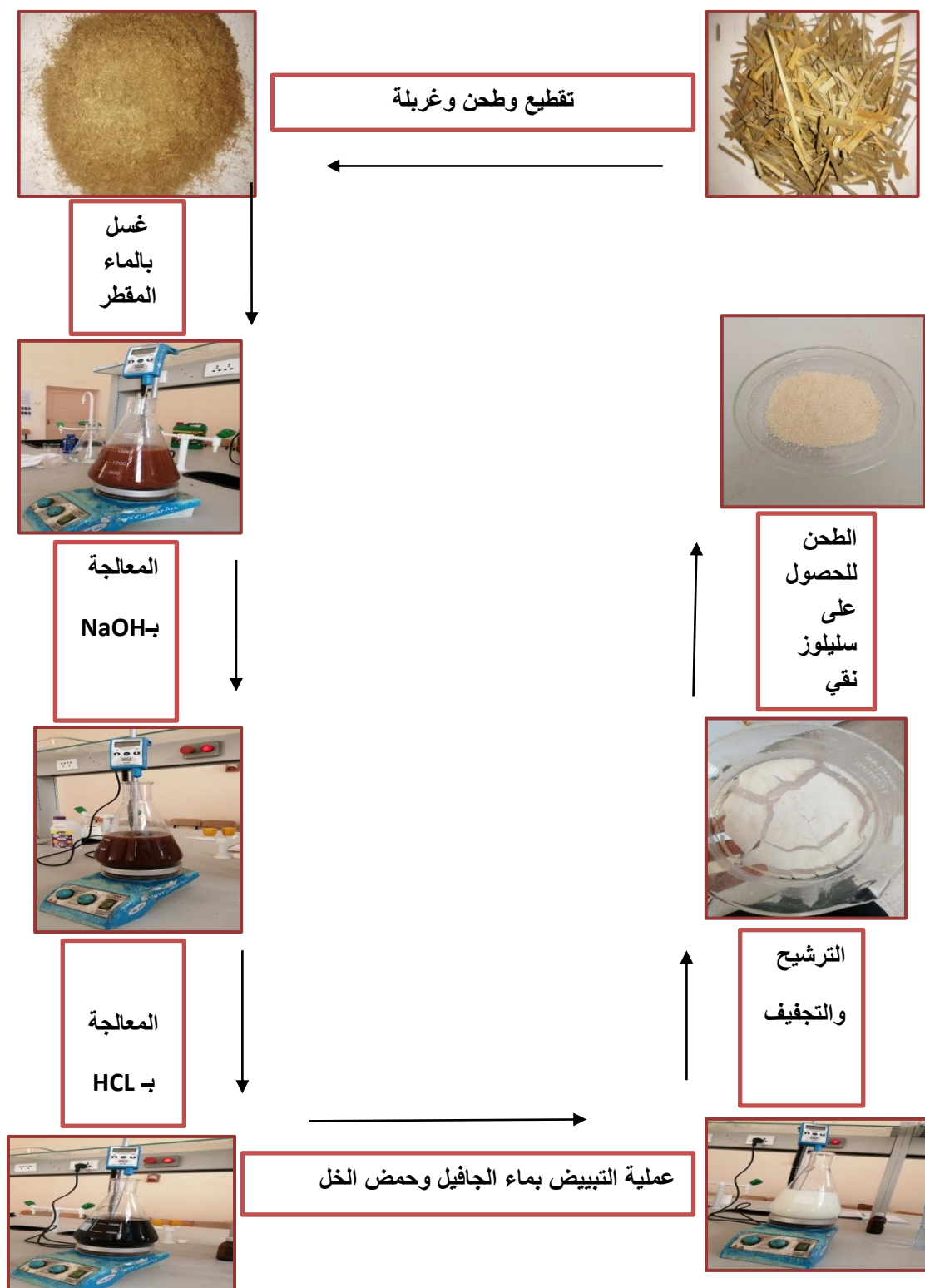
الشكل: (12.III): مخطط يوضح خطوات استخلاص السليلوز من سعف النخيل
