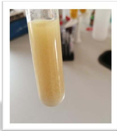
الشكل (1- IV): صورة لاختبار اليودوفورم على الإيثانول
