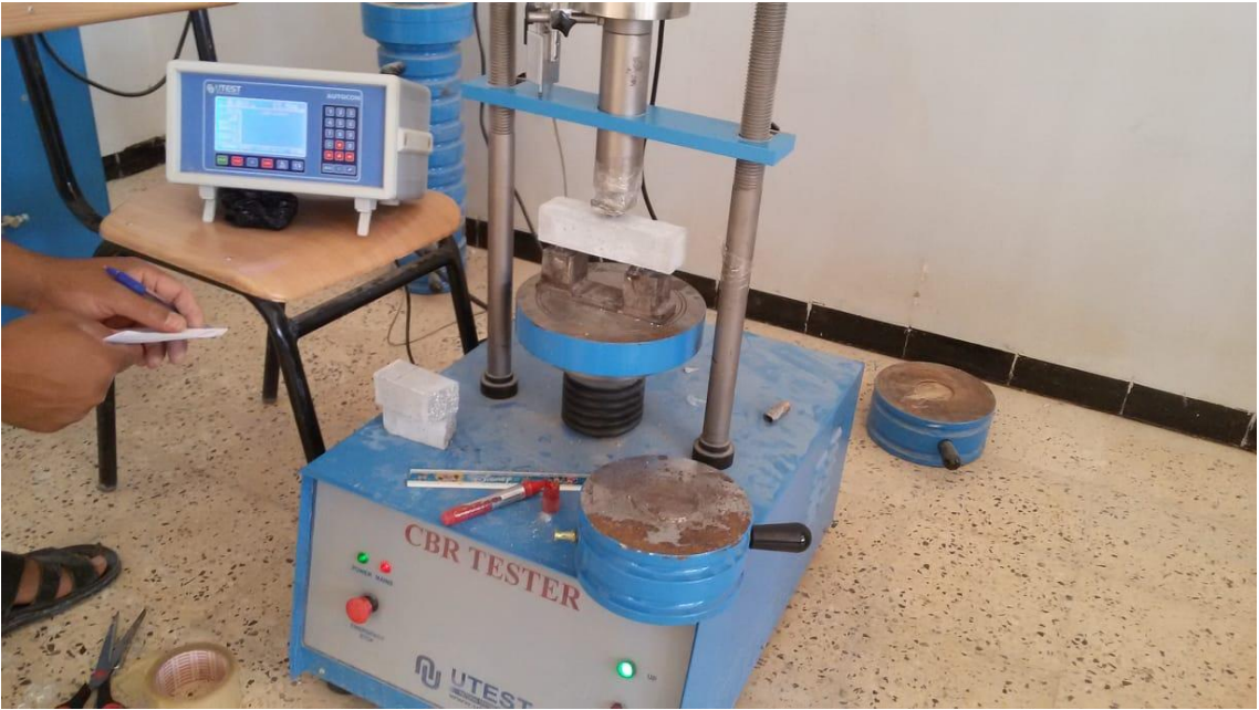
الصورة (3-IV) توضح شكل آلة التحطيم الخاصة بتجربة الإنحناء .
