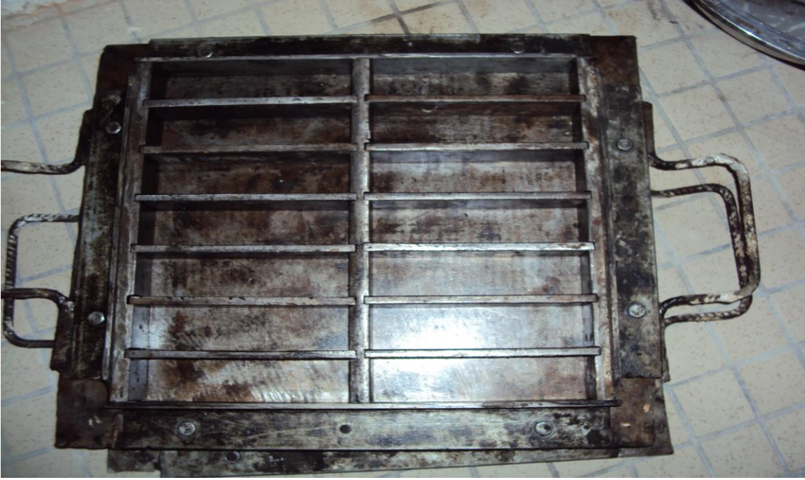
الصورة 9.III توضح أشكال القوالب المستعملة .
