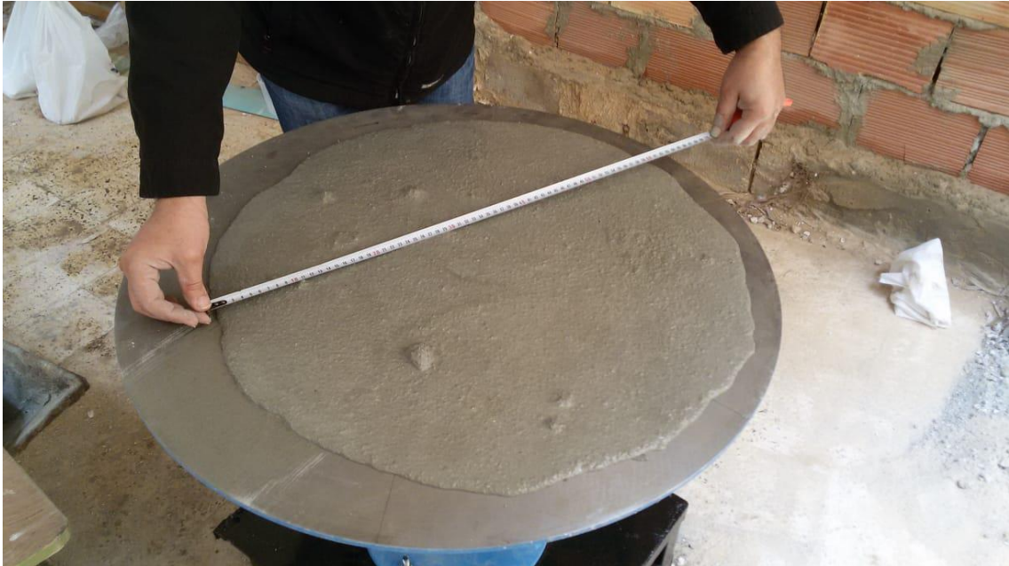
الصورة 8.III توضح قياس قطر العينة بعد عملية الهز.
