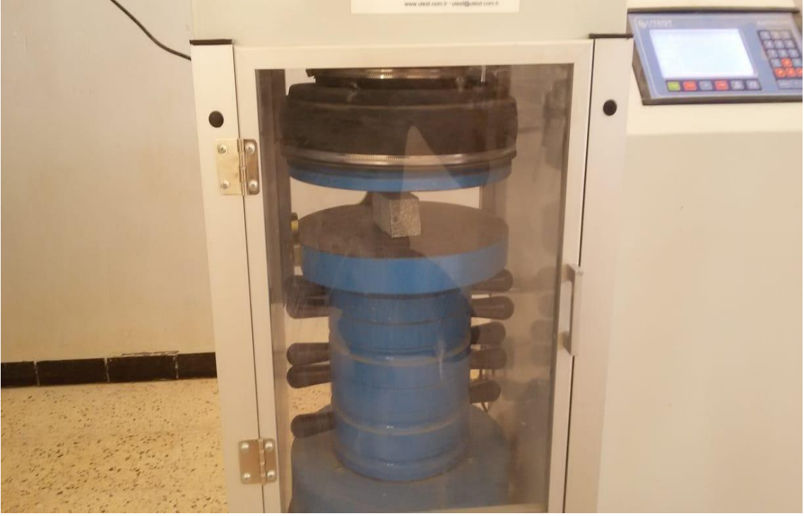
الصورة (2-IV) توضح شكل آلة التحطيم الخاصة بتجربة الضغط .
