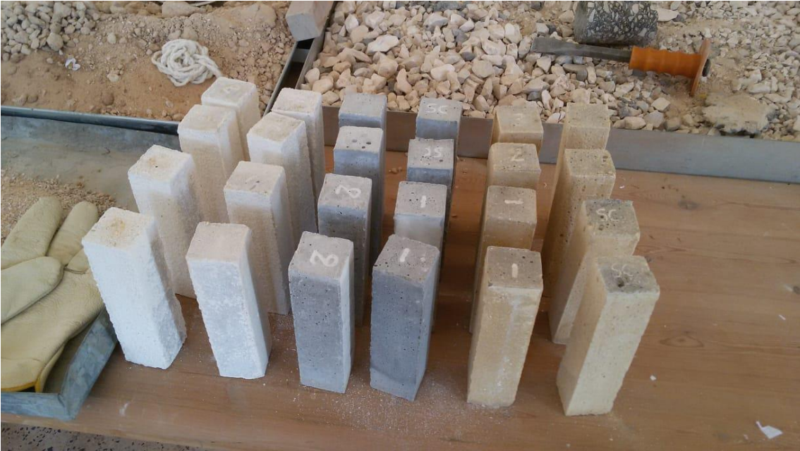
الصورة (1-IV) شكل العينات المعدة لقياس الضغط و الانحناء
