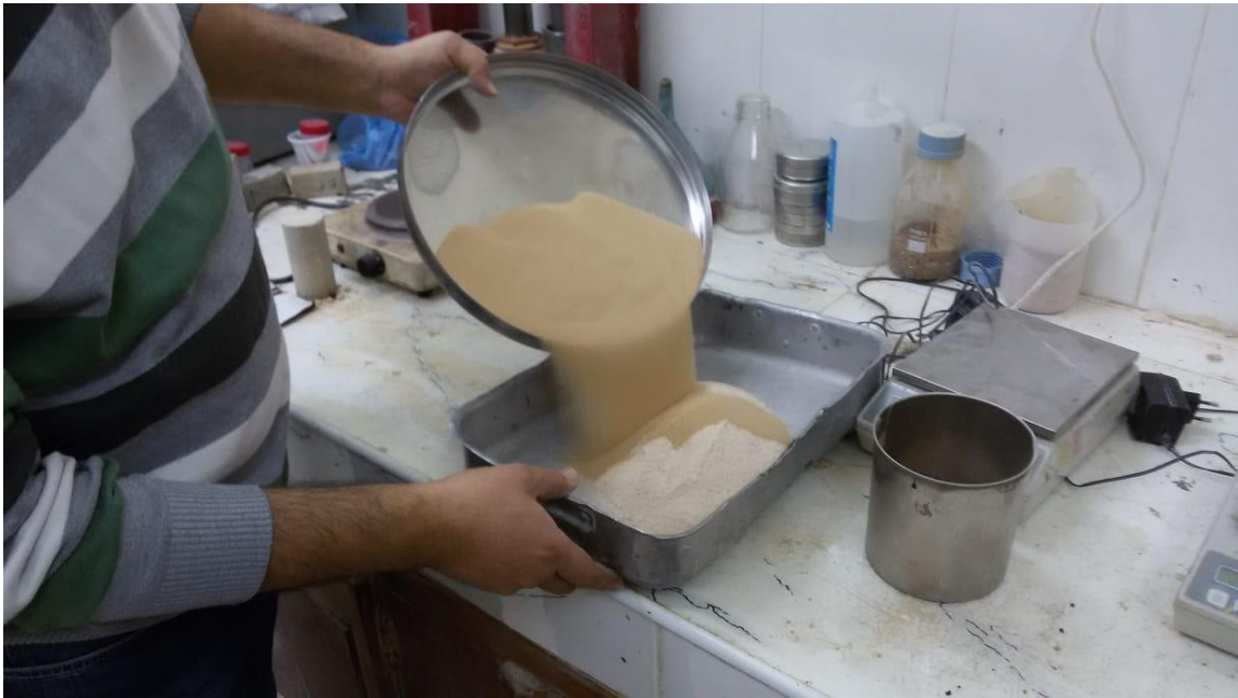
الصورة 6.III يبين الشكل طريقة خلط التركيبة رمل الكثبان + رمل المحاجر
