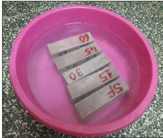
Figure II.13. Procédé de l'essai d'absorption d'eau par immersion.
