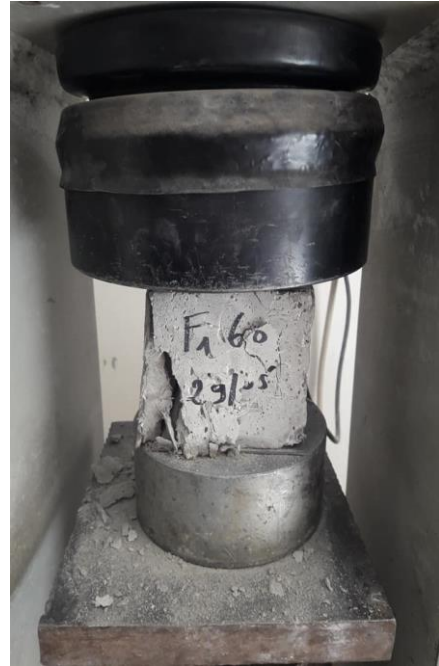
Photo N° 08. Essai de compression.
