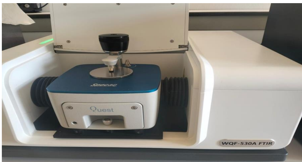
الوثيقة 8: جهاز التحليل الطيفي بالأشعة تحت الحمراء جهاز FTIR من نوع WQF-530A
