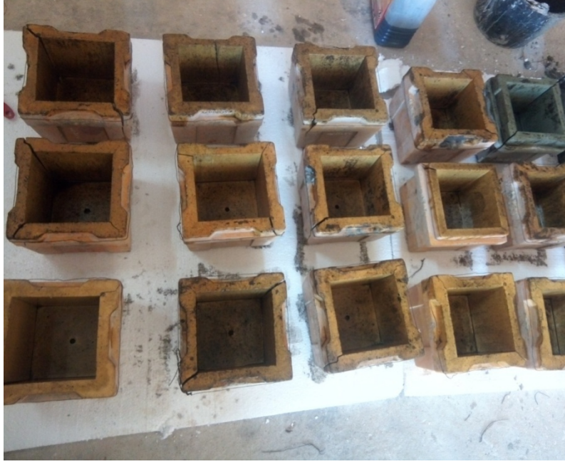
صور توضح تحضير القوالب قبل الصب للخرسانة
