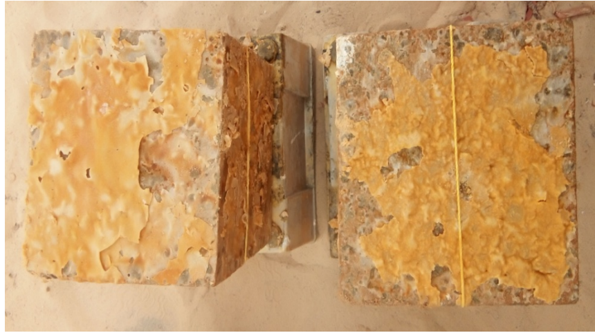
الصورة IV.1 توضح العينات من نوع CPJ بعد إخراجها من المحلول بعد مدة 90 يوما
