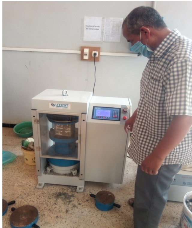
الصورة توضح تجربة قياس مقاومة الضغط
