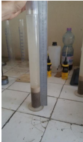
الشكل:1.III. تجربة المكافئ الرملي
