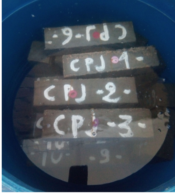
الصورة توضح العينات بعد غمرها في الوسط
