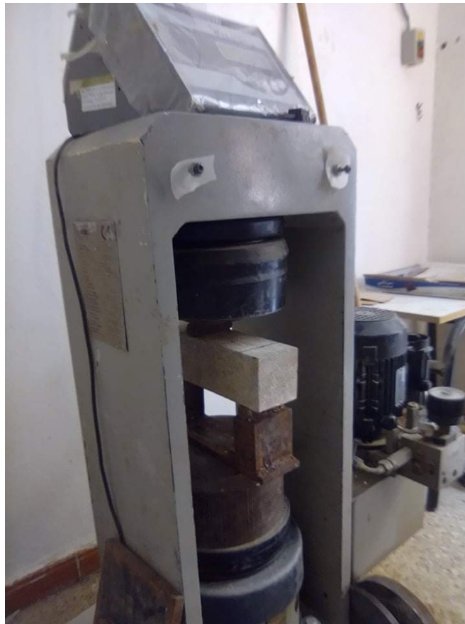
الصورة توضح تجربة قياس مقاومة الشد عن طريق الإنحناء
