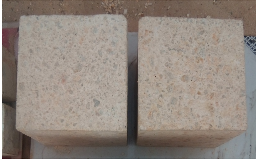
الصورة IV. 3 يوضح العينات من نوع CPJ بعد إخراجها من الوسط الحمضي بعد مدة 90 يوما وغسلها
