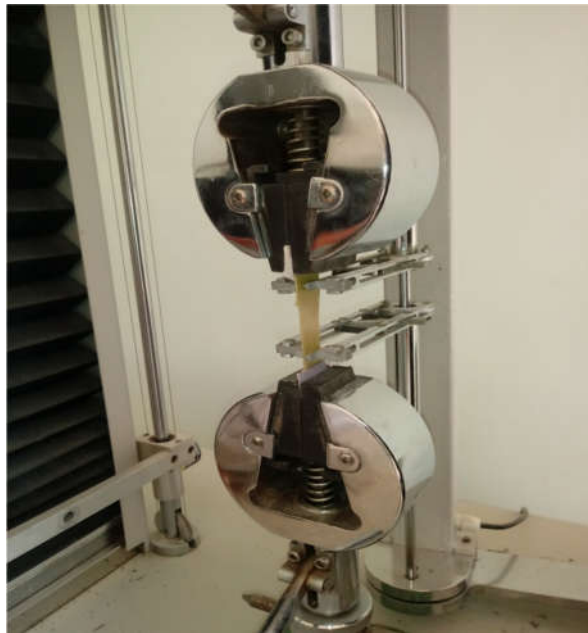
Figure III.12. Image de l'appareillage (machine) de traction
