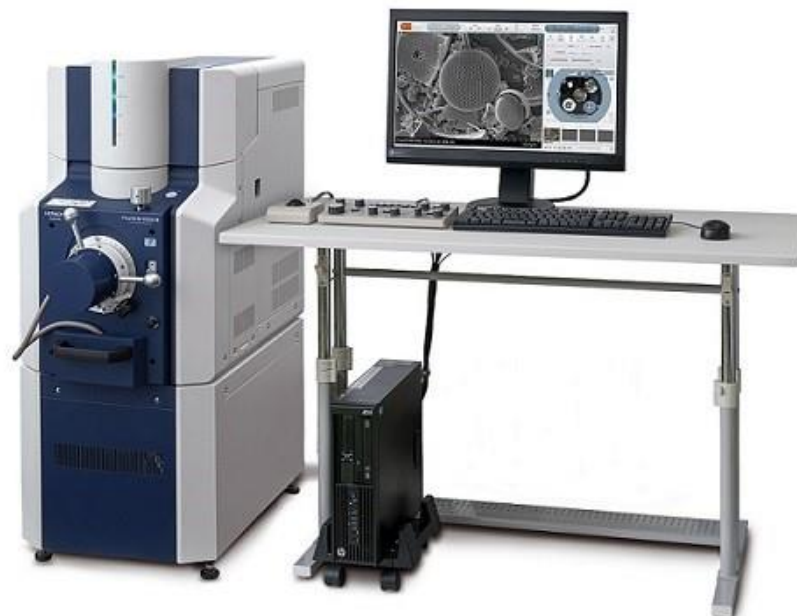
Figure III.7. Appareil Microscopie électronique à balayage (MEB)
