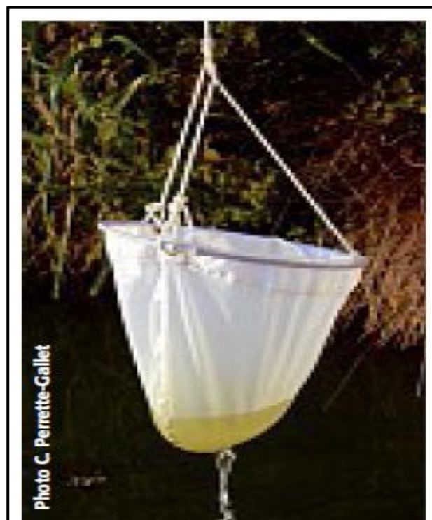
Figure15 : filet à plancton (Charpy L., 2009).
