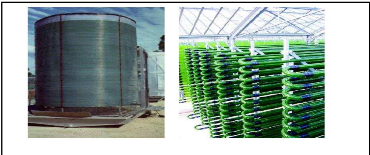
Figure 26 : photo d'un photobioréacteur de type BIOCOIL (1000 litres) en Australie (université de Murdoch) (à gauche) et d'un photobioréacteur de type serpentin utilisé en Allemagne (société roquette) et à Almeria (à droite) ( Salomez M., 2009 ).
