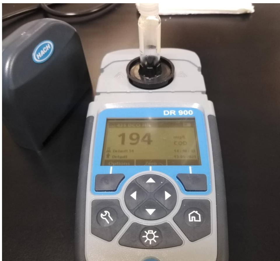
Figure I.7: Spectrophotomètre DR 900 pour la mesure de la demande chimique en oxygène (DCO).[22]
