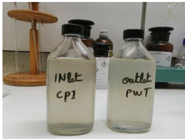
Figure II. 8: Tube de échantions de l'eau avant et après le traitement.
