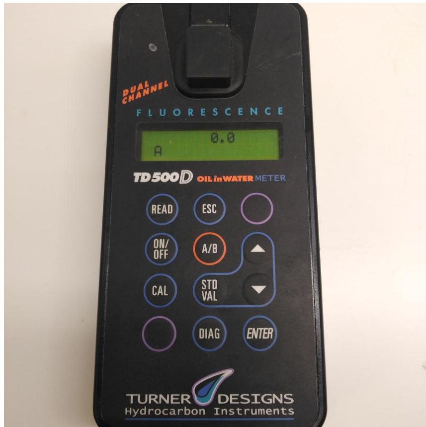
Figure I.4: Analyseur TD500 pour analyser les hydrocarbures dans l'eau.[22]
