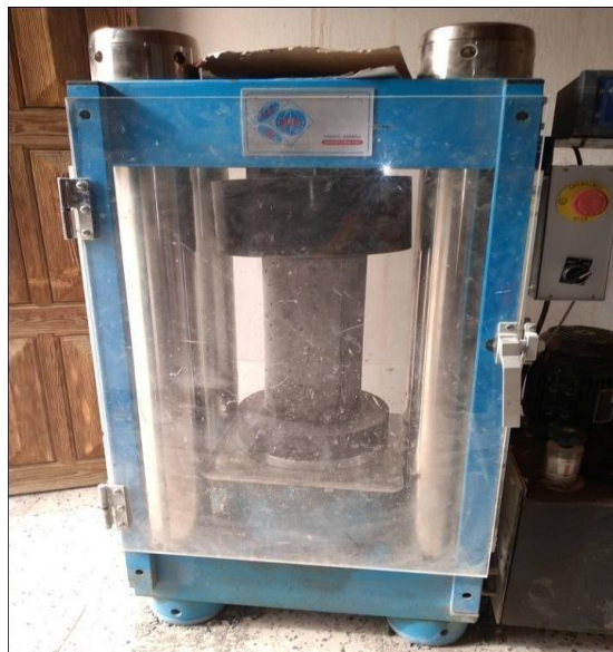
Photo III.8 : La mise en place d'éprouvette dans la machine
