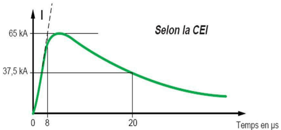
Figure III.2: courant de choc de foudre en fonction de temps.
