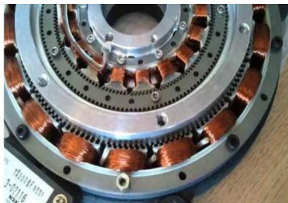
Fig. I.6. MRV Vernier "à petites dents" à stator externe et interne [Ka15].
