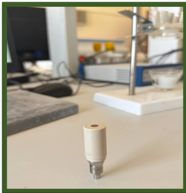
الشكل III-2: قطب العمل لجهاز الفولتاممري.
