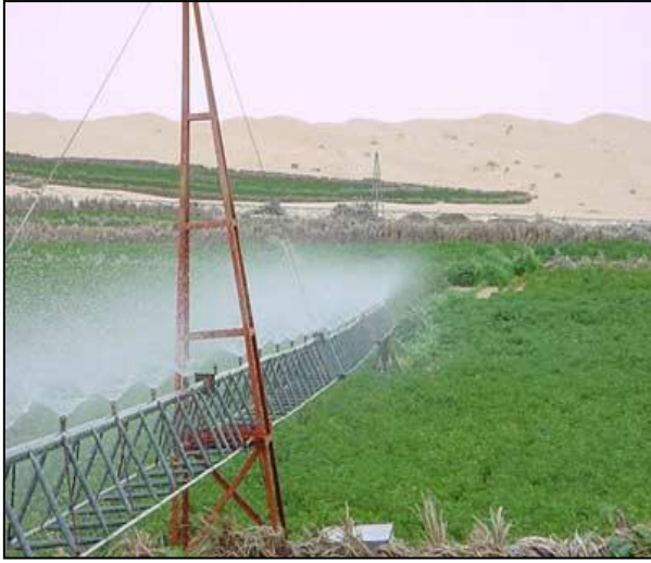
صورة 16:الجيل الثاني السقي بالمحركات الكهربائية
