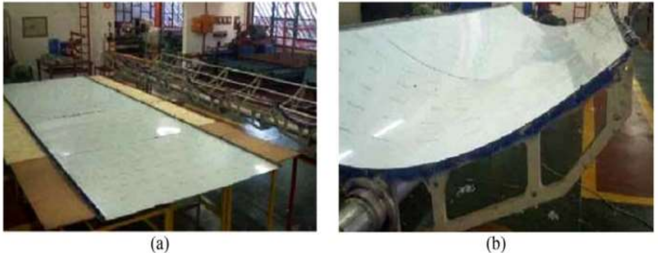
Figure I. 16 : Assemblage du collecteur cylindro-parabolique « (a) en acier inoxydable avant l'installation et (b) en adoptant une forme parabolique » [42].
