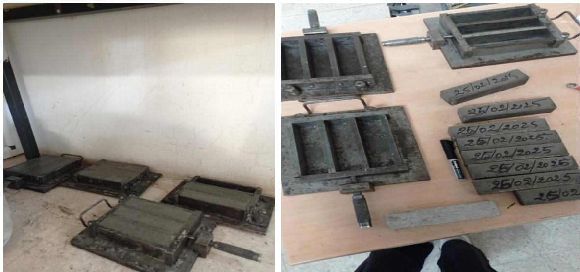
figure II 13 : les étapes de Moulage des éprouvettes
