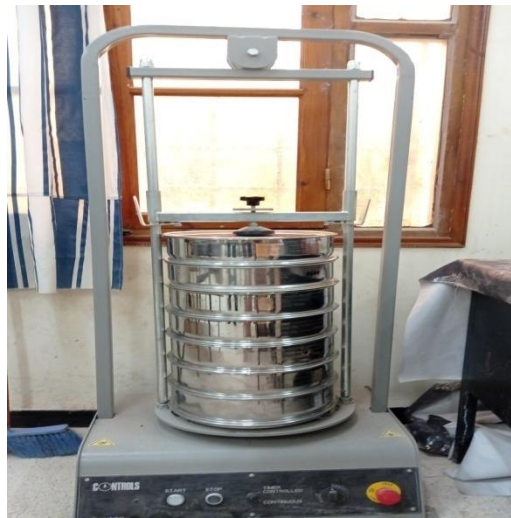
figure II 5 : Tamis d'analyse granulométrique.
