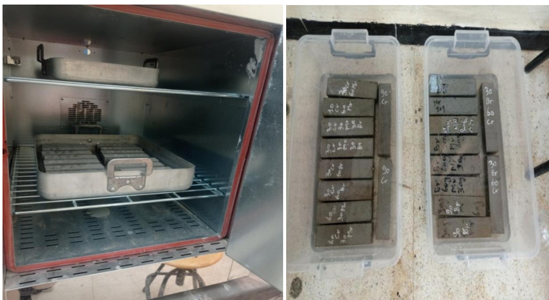
figure II 17 : Essai d'absorption par immersion.
