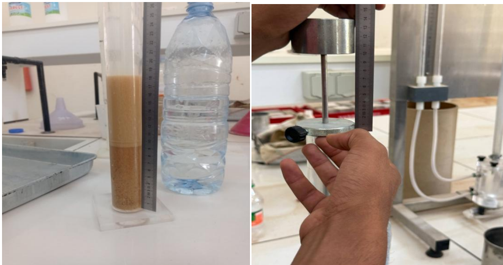
figure II 8 : Essai de l'équivalent de sable
