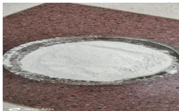
figure II 1 : Déchets de marbre.
