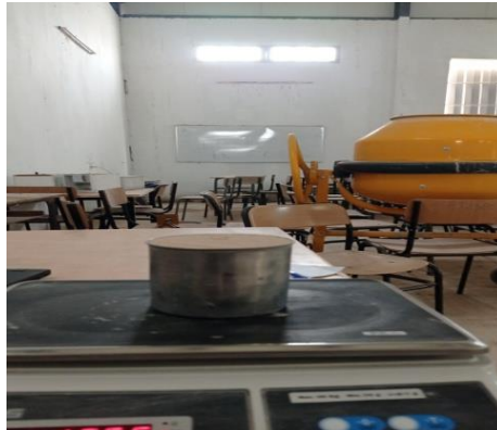
figure II 6 Essai de la masse volumique apparente.
