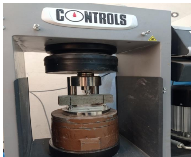
figure II 15 : Essai résistance à la flexion.
