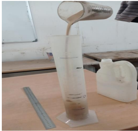
figure II 7 : Essai de La masse volumique absolue.
