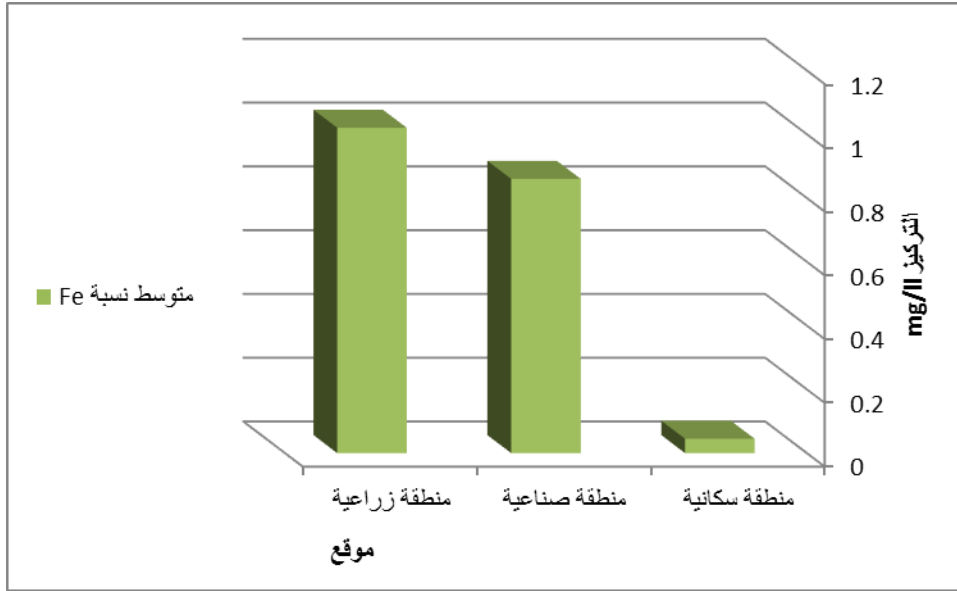
الشكل 15: الأعمدة البيانية توضح متوسط تركيز الحديد في مياه الري
