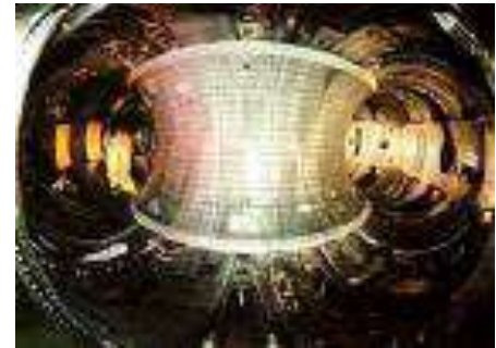
الشكل (10.I): جهاز توكاماك (Tokamak) لحصر للبلازما [1].
