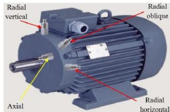
Figure II.4. Différents points de mesure des vibrations d'une MAS.
