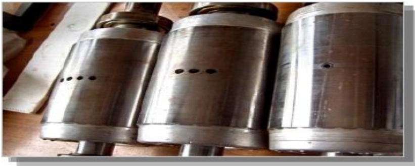
Figure I.9. Défaut de rupture de barres
