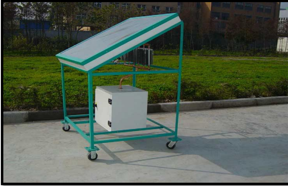
الشكل (13-1): صورة توضح آلة التبريد الشمسية بالإمتزاز [29].
