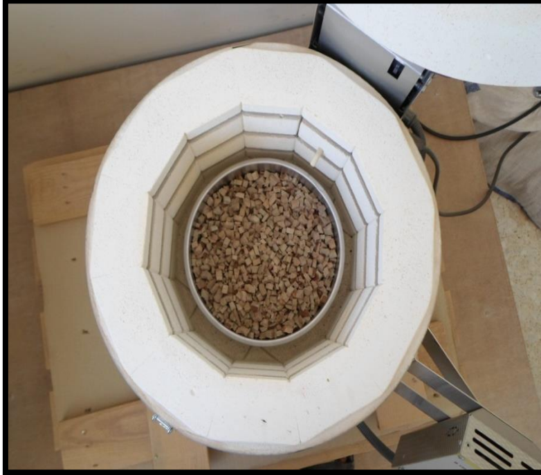
الشكل (8-3): وضع قطع خشب الصنوبر داخل الفرن.
