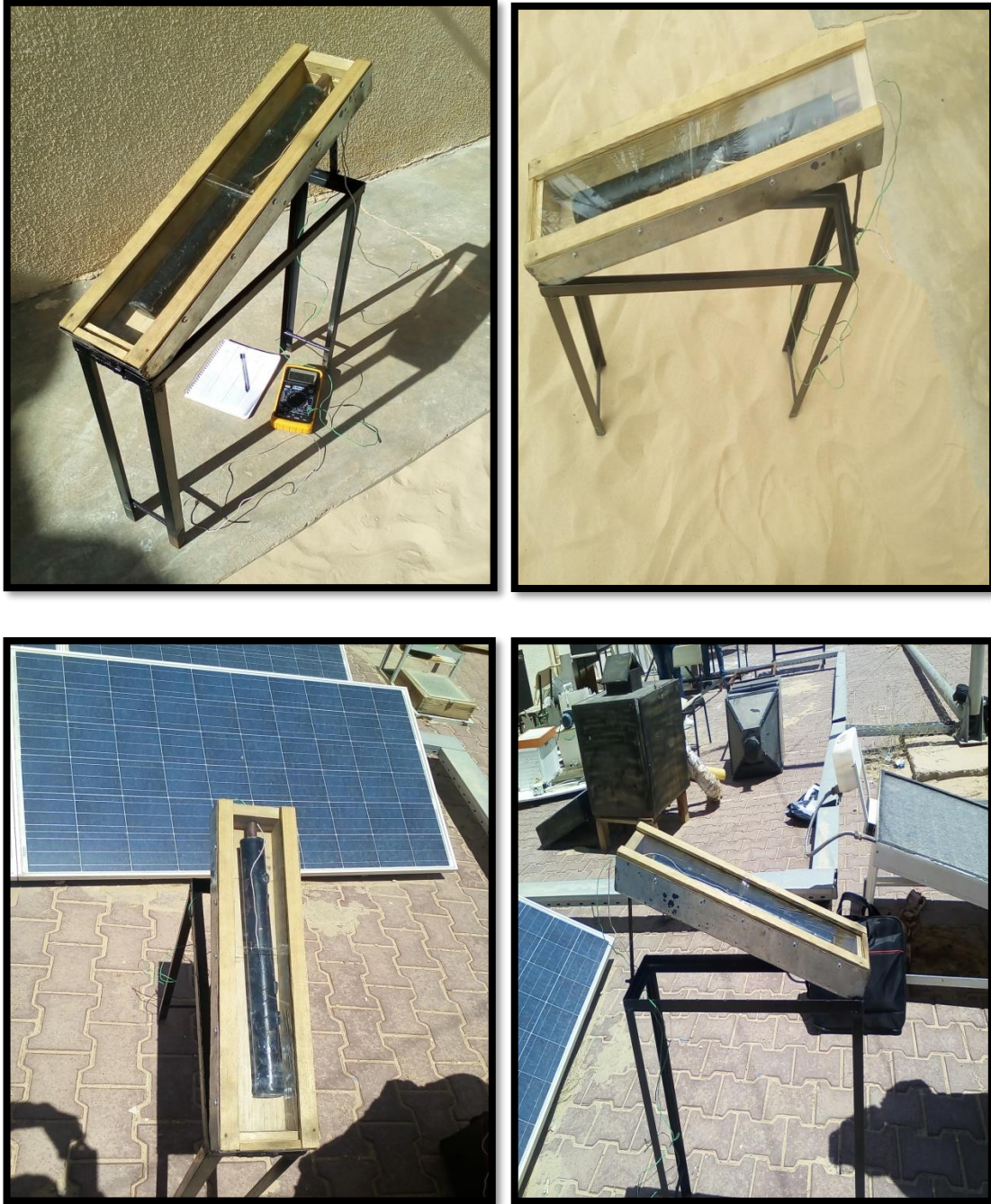
الشكل (20-3): يوضح اللاقط معرض للإشعاع الشمسي أثناء التجربة.
