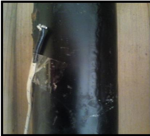
الشكل (3-19): يوضح تموضع المزدوج الحراري على الأنبوب وداخله.
