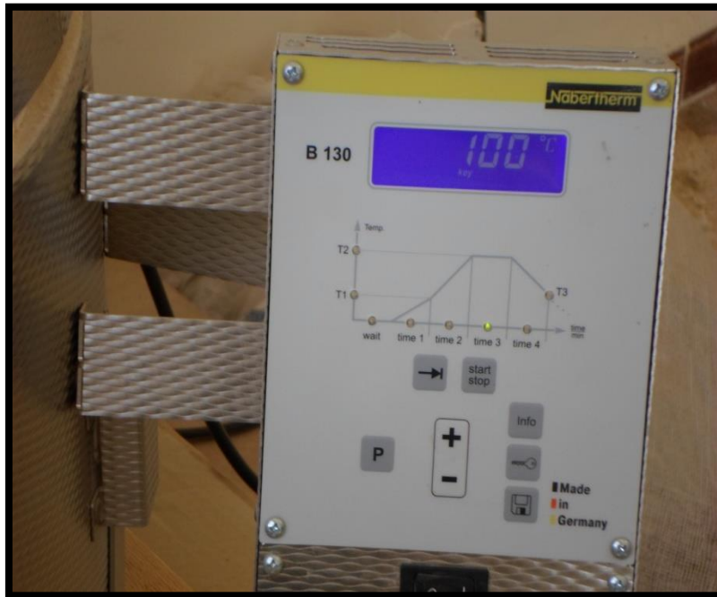
الشكل (9-3): يوضح تثبيت درجة حرارة الفرن للتجفيف.
