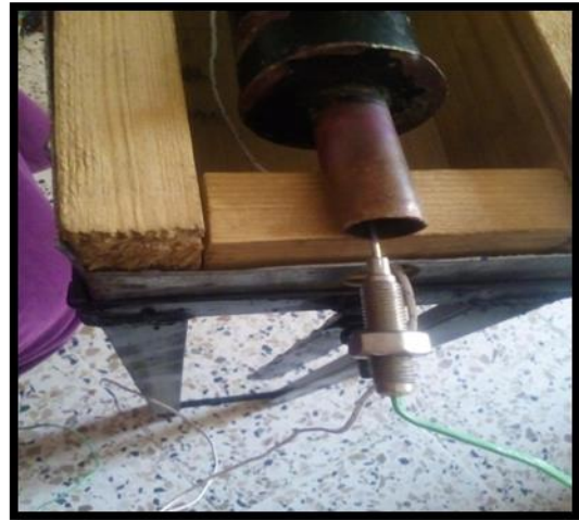
الشكل (3-19): يوضح تموضع المزدوج الحراري على الأنبوب وداخله.
