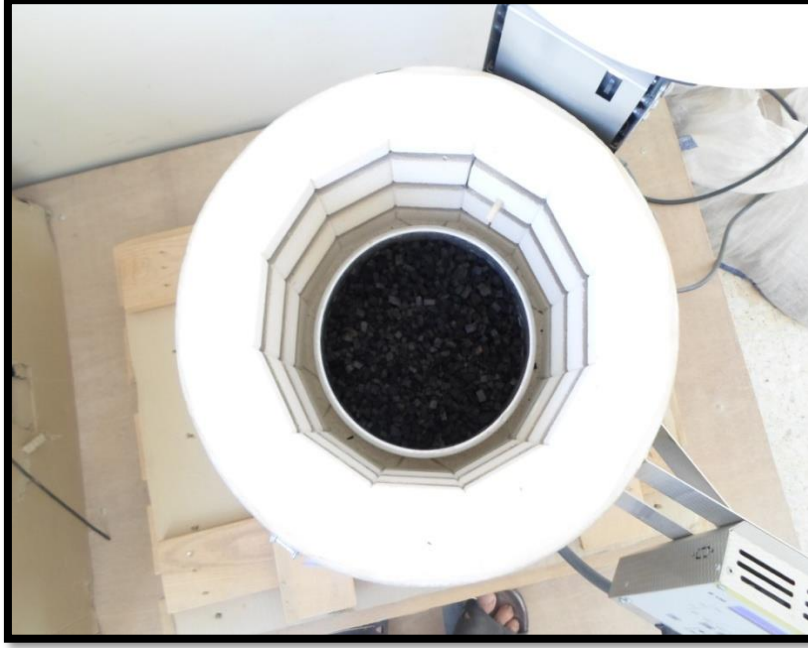
الشكل (3-12): يوضح العينة داخل الفرن أثناء مرحلة الحرق.
