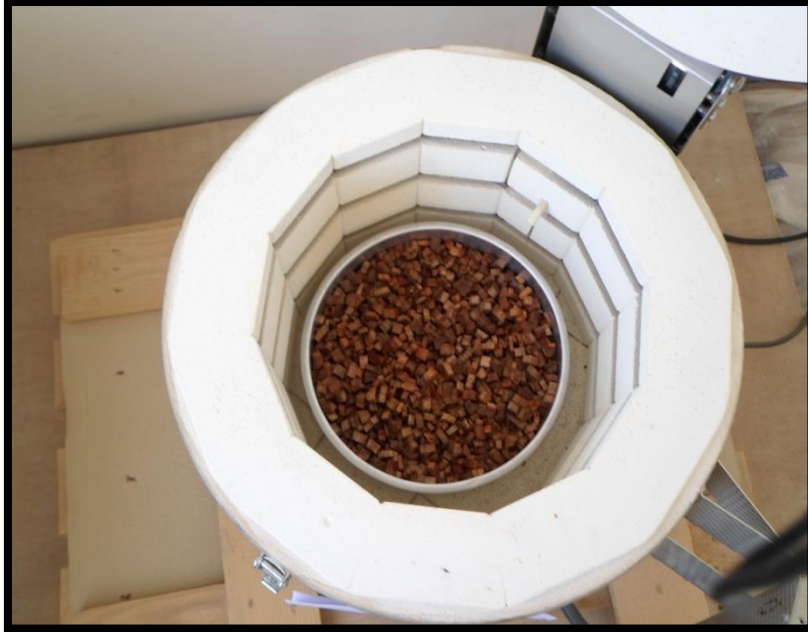
الشكل (3-10): يوضح العينة في الفرن بعد مرحلة المعالجة الكيميائية.
