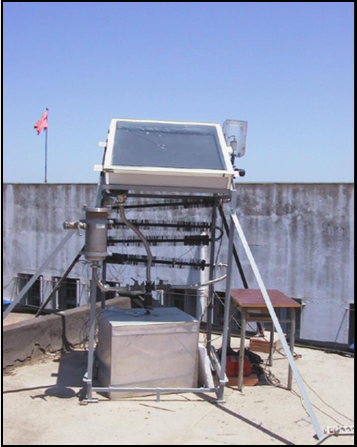
الشكل (31-3): جهاز تليج شمسي مصمّم يعمل بالزوج (الكربون المنشط/ميثانول) [50].
