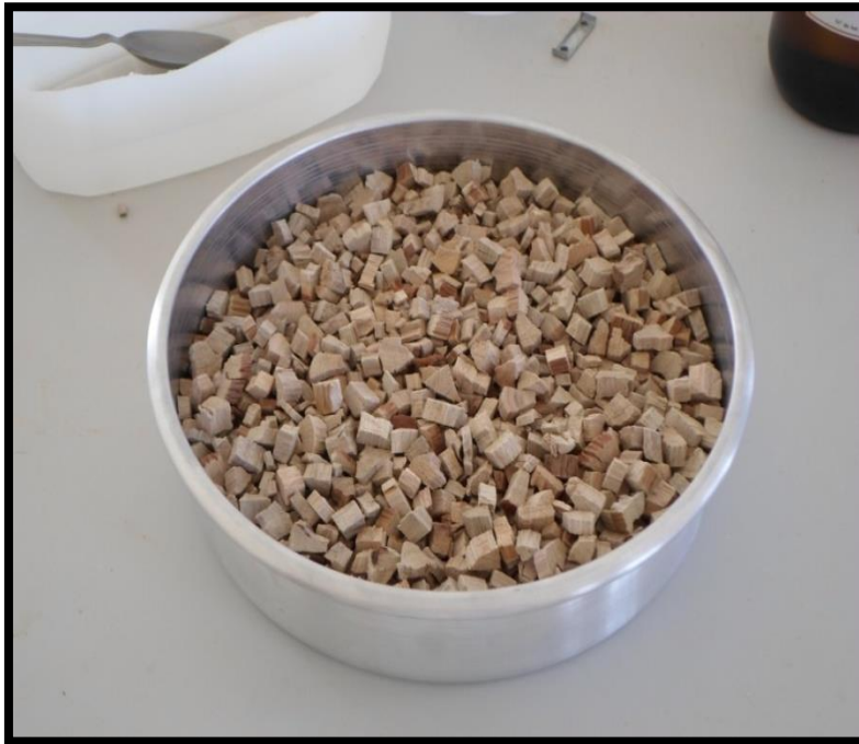
الشكل (3-7): يوضح قطع خشب الصنوبر لتحضير العينة.
