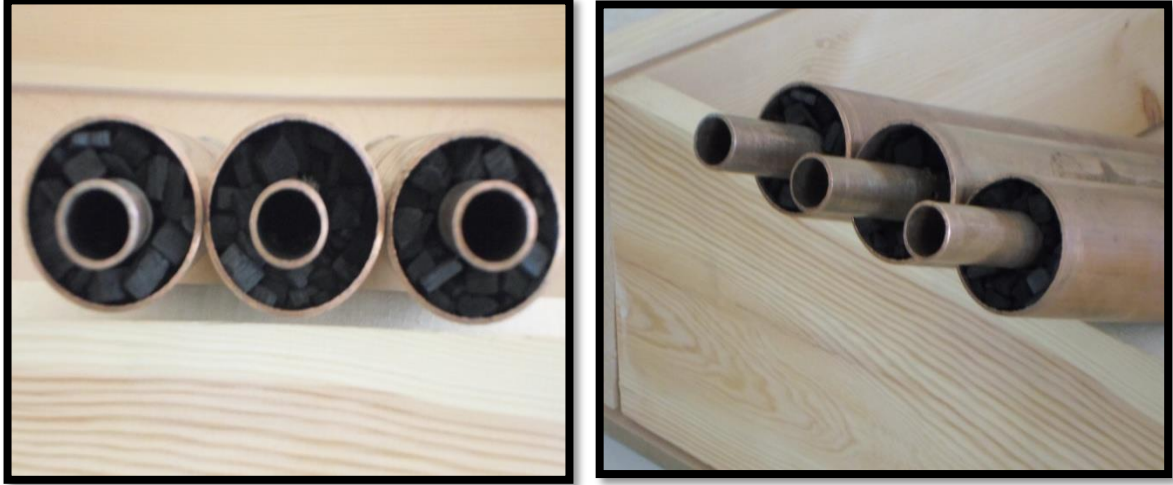
الشكل (3-4): يوضح تداخل الأنبوتين وبينها الكربون المنشط.
