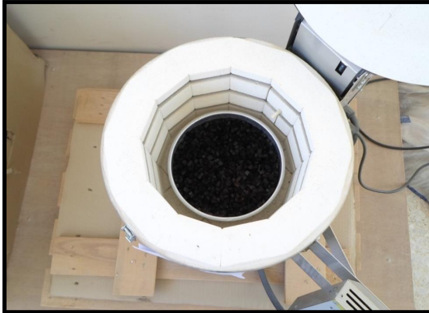
الشكل (3-13): يوضح عملية الكربنة للعينة داخل الفرن.
