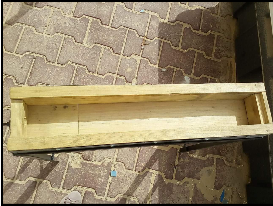
الشكل (1-3): يوضح صندوق اللاقط الشمسي المحضّر للتجربة.
