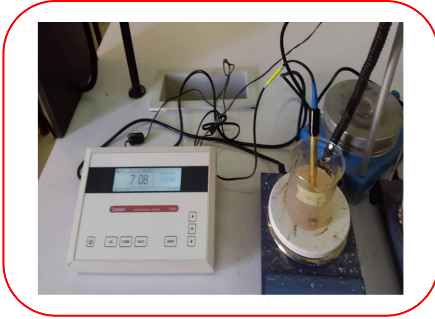
الشكل (10-IV): يوضح عملية تعديل درجة الحموضة بواسطة H_2SO_4 .
