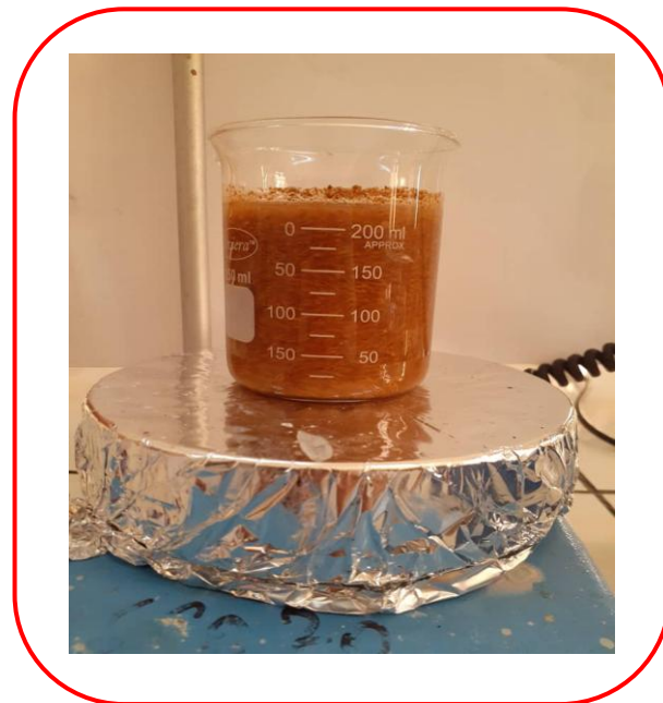
الشكل (5-IV): يوضح معالجة قشور الفول السوداني المطحونة بواسطة محلول HCl.
