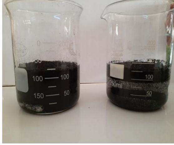
الشكل (8-IV): يوضح معالجة العينات المحروقة بواسطة محلول NaOH.
