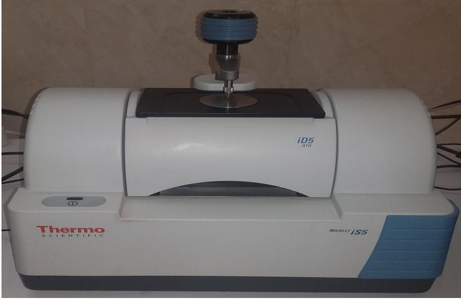
الشكل (15-IV): طريقة وضع العينة في جهاز IR-ATR .
