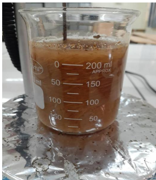
الشكل (6-IV): يوضح معالجة قشور الجوز المطحونة بواسطة محلول HCl.
