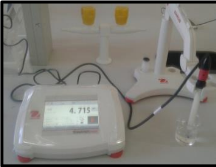
الشكل (3.IV): جهاز الـpH-mètre
