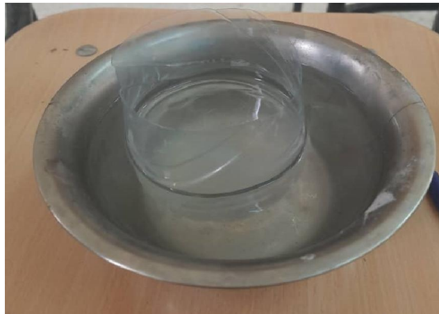
Fig. III.16 : Mettez le mélange dans un récipient d'eau tiède à 50°C.
