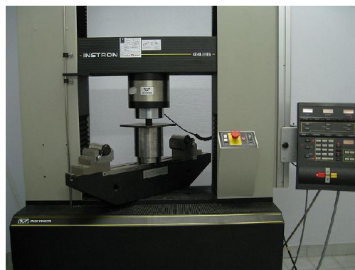
Fig. II .5 : Essai de compression d'un cylindre en matériau composite sur une machine d'essai universelle.
