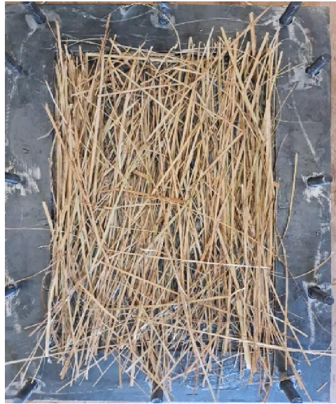
Fig. III.12 : Disposez les feuilles de palmier sur le moule.
