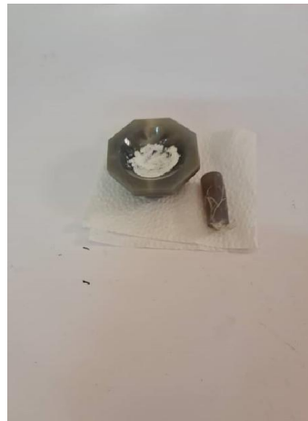
Fig. III.24: 0,198 g de poudre de KBr broyé avec 0,02 g des fibres de feuilles de palmier avec traitement.
