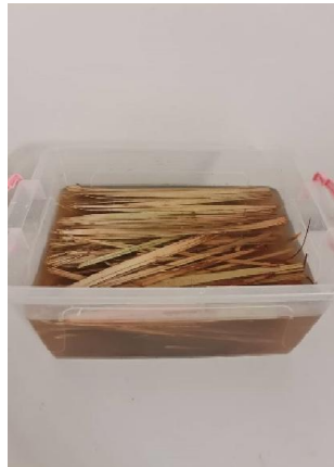
Fig. III.10 : feuilles de palmier trempées dans une solution de NaOH.
