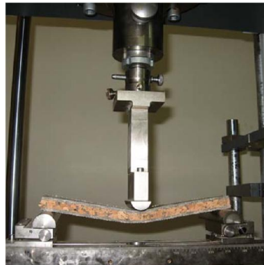
Fig. II .3 : Essai de flexion sur machine de flexion.
