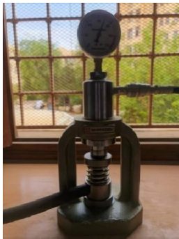
Fig. III.26: comprimé à une pression de 70 KN pendant 2 minutes.
