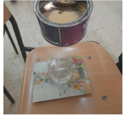
Fig. III.15 : mélangez la résine avec le durcisseur.
