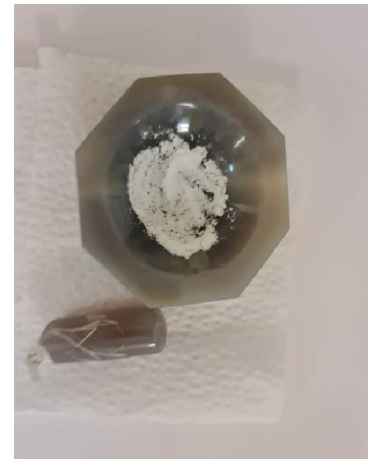
Fig. III.25: 0,198 g de poudre de KBr broyé avec 0,02 g des fibres de feuilles de palmier sans traitement.
