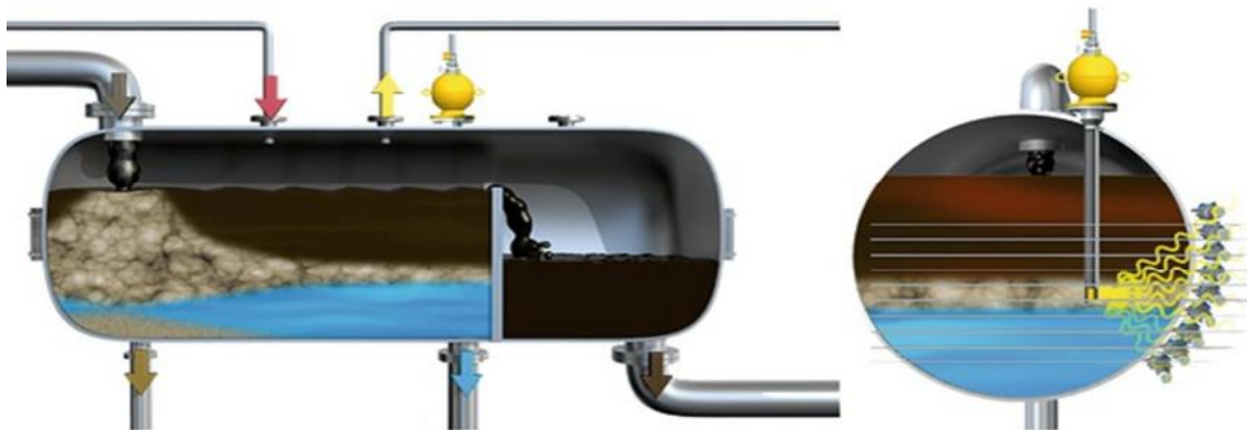
Figure II.8: Séparateur de pétrole.
