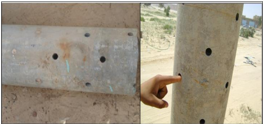
Figure 36 : Conduite d'amiante ciment utilisée dans le réseau drainage horizontale
