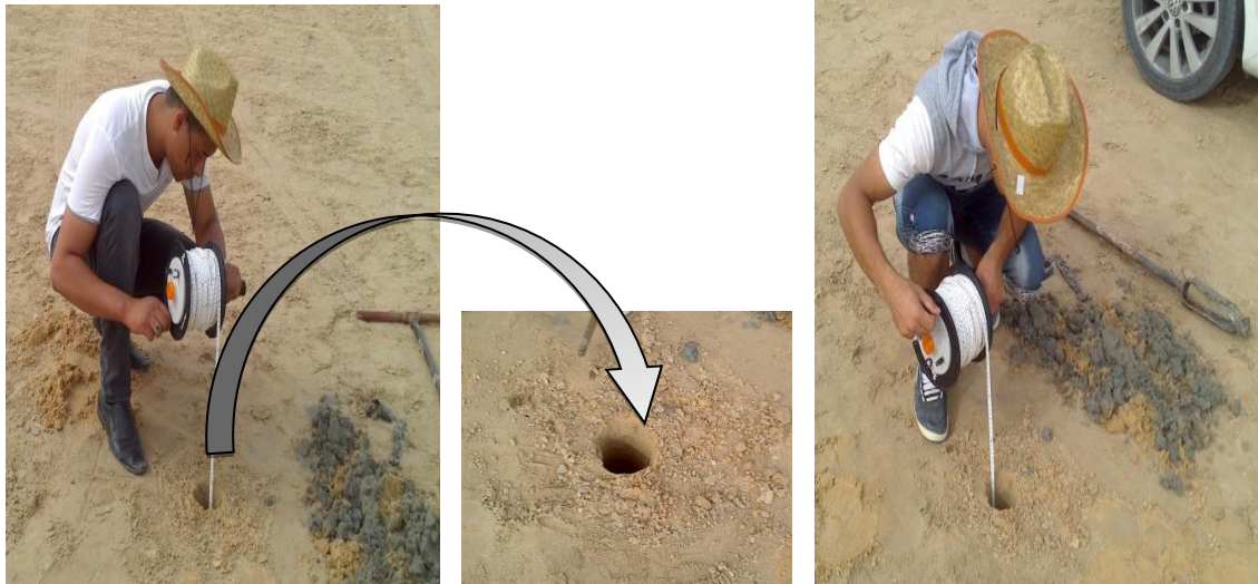
figure 75 :la mesure de NS par la sonde électrique
