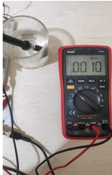
صورة III - 25 : تمثل قيمة الملي فولت الصادرة من الحساس عند وضعه في الماء المقطر.
