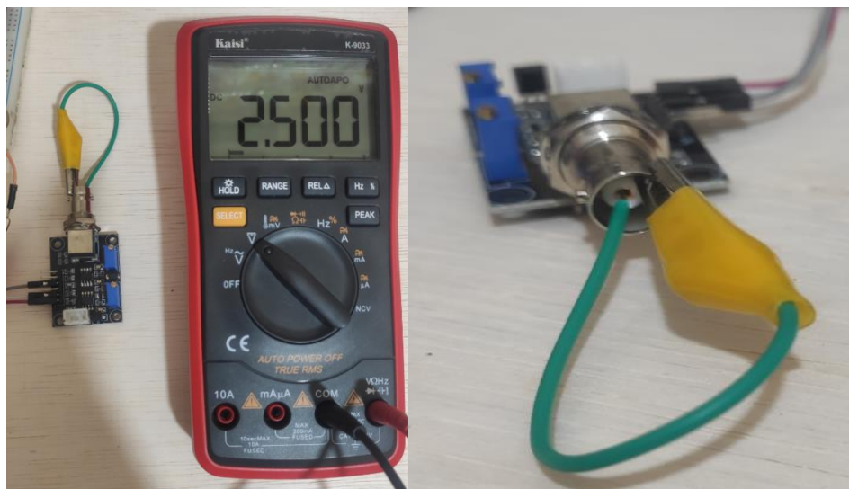
صورة III - 15 : تمثل طريقة ضبط قيمة الفولت بإزاحة 2.50 فولت .
