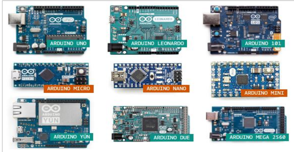
صورة III - 5 : تمثل بعض أنواع لوحات Arduino .
