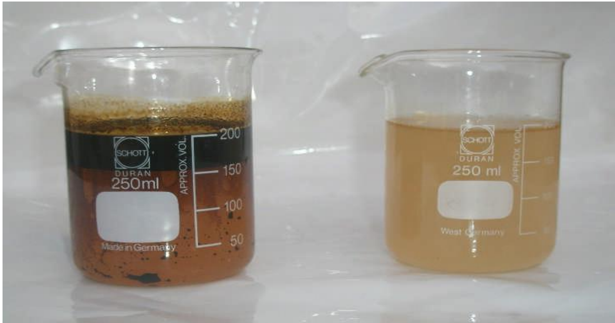
Figure IV-32: Eau huileuse : avant et après le traitement
