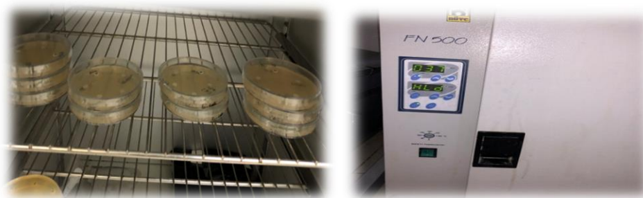
Figure 56. L'incubation des boites de Pétri à l'étuve pendant 24 heures à 37 °C.
