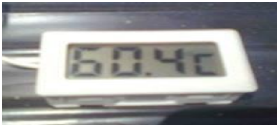
Figure II-11: Thermocouple ou degré qui permet de vérifier la température de substrat.
