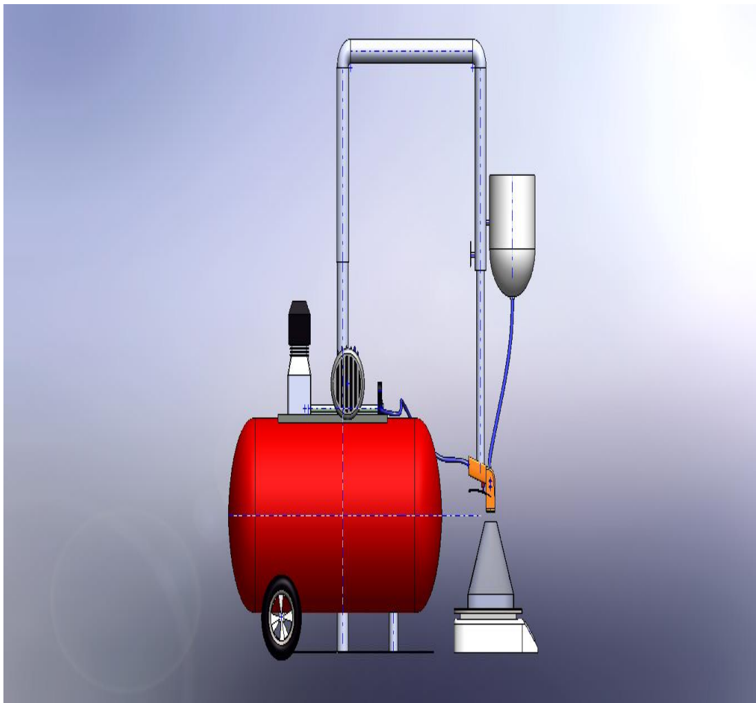
Figure II-12: Montage complet de spray pyrolyse.
