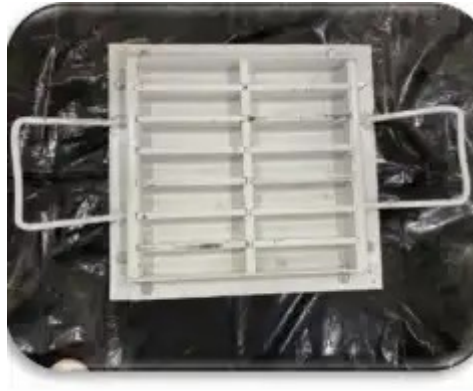
Figure. III .9. Moule des éprouvettes utilisés.
