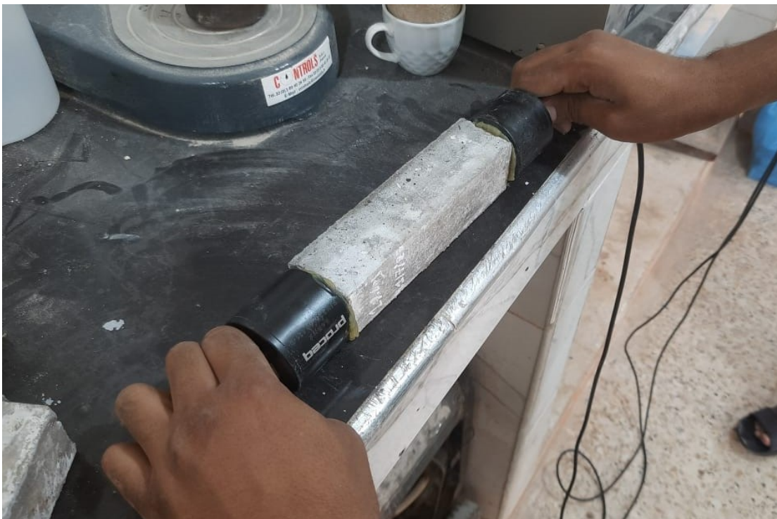
Figure. II.25. Essai d'auscultation dynamique.
