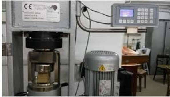
Figure. II.23. Essai de de traction par flexion.
