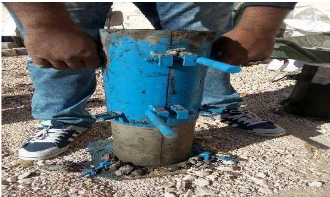
الشكل 11.III : نزع القالب عن عينة الاختبار
