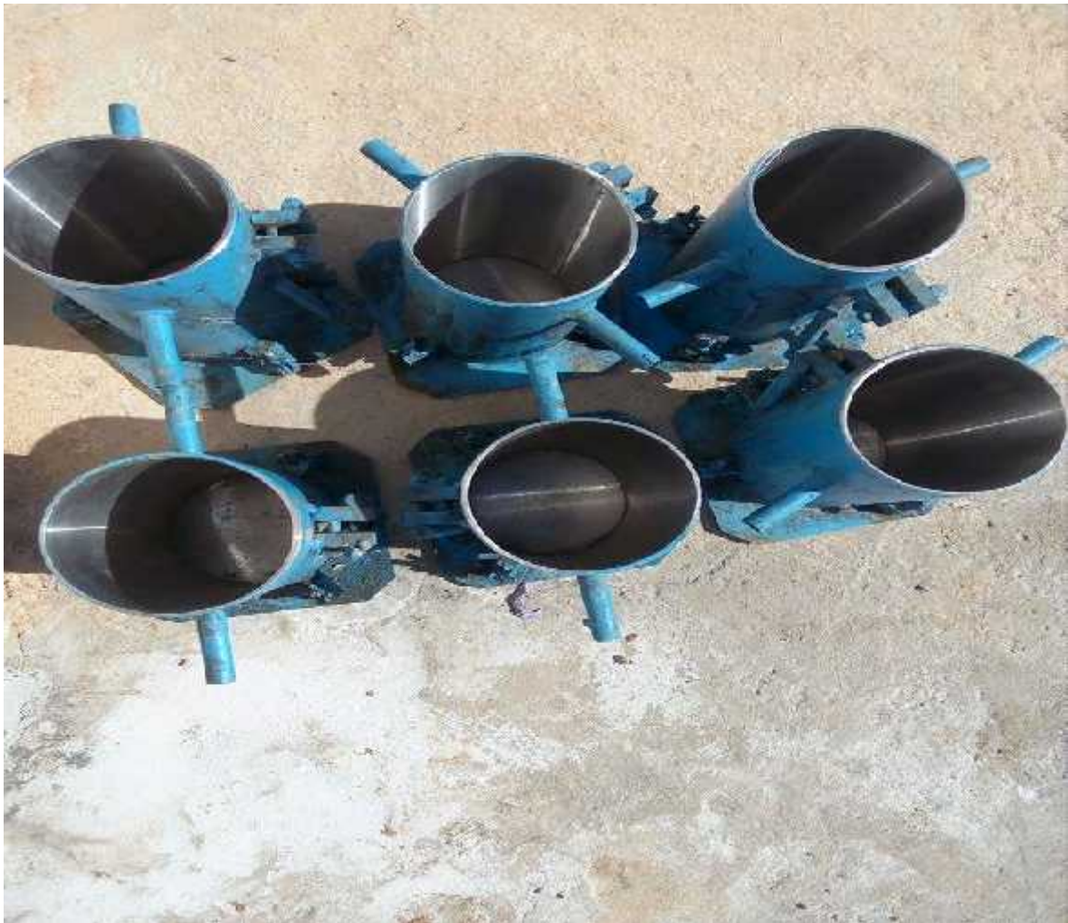
الشكل III 9. قوالب الصب
