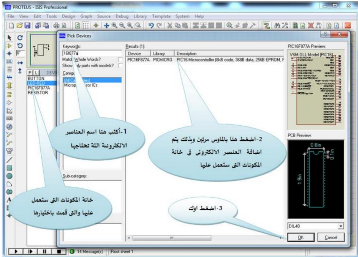
- الشكل (3-4): نافذة توضح كيفية اختيار الميكروكنترولير المناسب -
