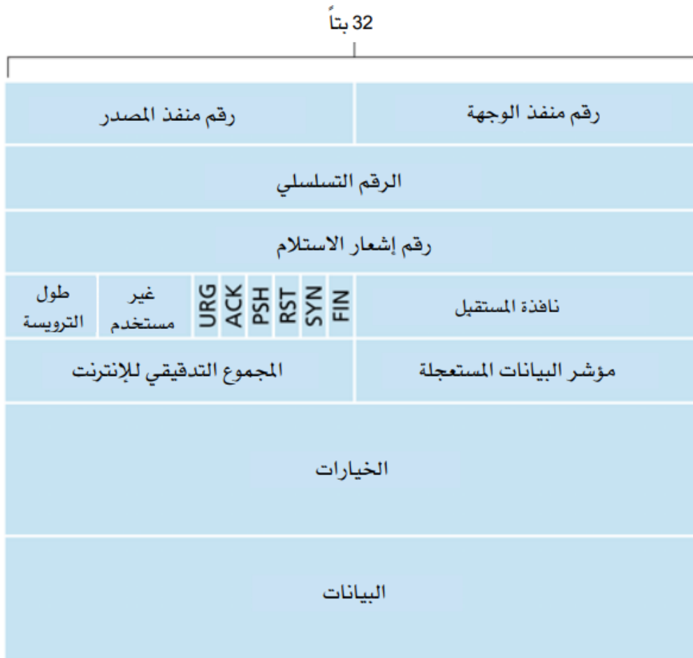
الشكل 2-4 صيغة قطعة بيانات بروتوكول TCP [44]
