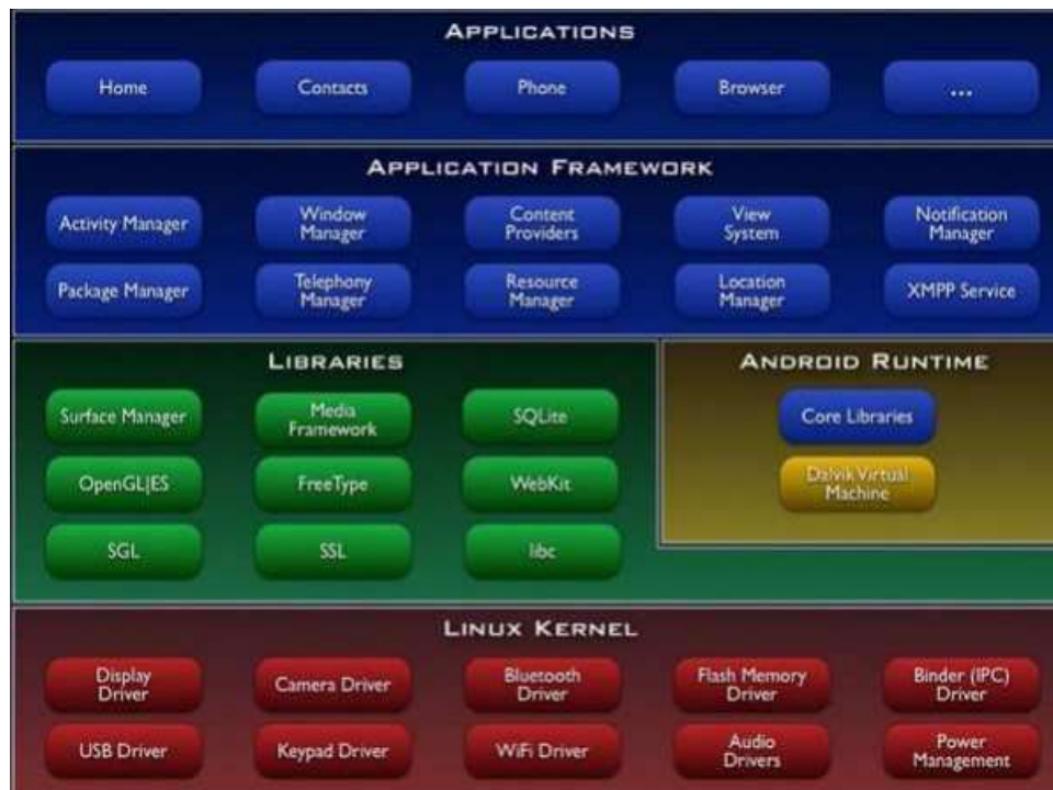
Figure10: Architecture de la plateforme Android.
