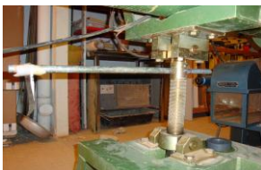
Photo 6 : système vis-écrou utilisé pour la variation de la pente du canal
