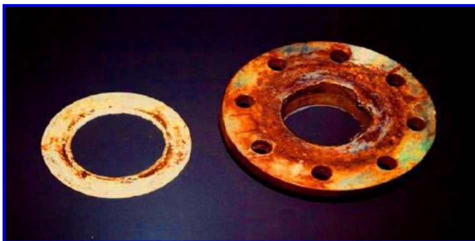
الشكل (8.I): التآكل الشقي.
