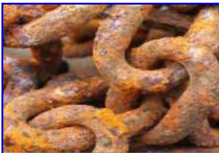
الشكل (2.I): صورة للتآكل المنتظم (العام).
