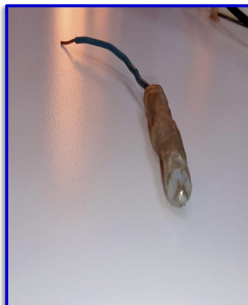
الشكل (4.II): صورة لقطب العمل (WE).
