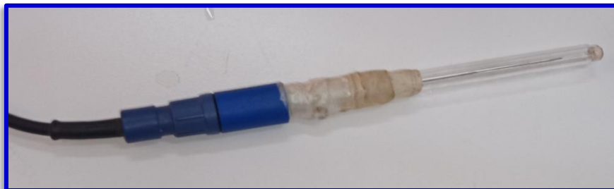
الشكل (3.II): صورة لقطب المرجع (Ag/AgCl/KCl) RE.
