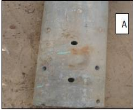
(a) Conduite d'amiante ciment utilisée dans le réseau de drainage
