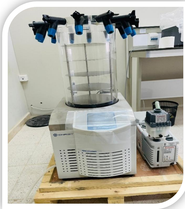
الشكل 3.I. جهاز التجفيف بالتجميد Lyophilisateur
